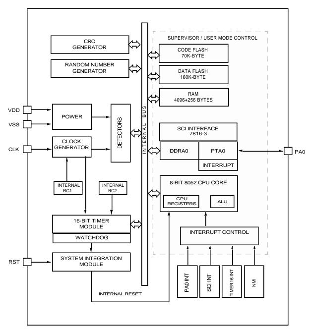
Figure 1. μT83SCB230 MCU Block Diagram
